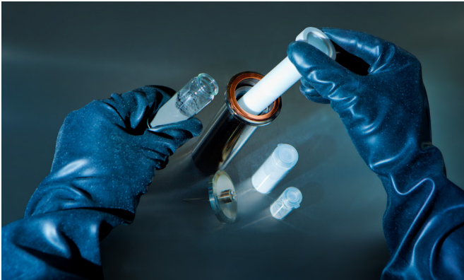
Zusammensetzen einer Na/NiCl 2 -Zelle.
